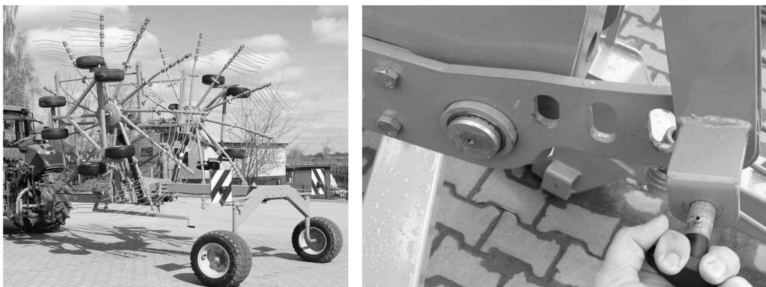
Рис. 20. Транспортная позиция (возможность изменения ширины захвата)
