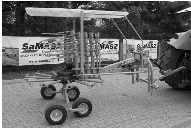
Рис. 13. Грабли соединены с трактором с помощью дышла
