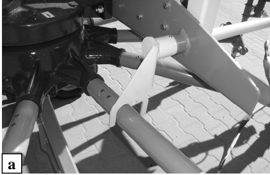
Рис. 12. а) Блокировка редуктора во время транспортировки (защита поднята в вертикальную позицию), б) Блокировка во время работы (защита опущена в горизонтальную позицию)
