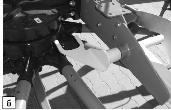
Рис. 12. а) Блокировка редуктора во время транспортировки (защита поднята в вертикальную позицию), б) Блокировка во время работы (защита опущена в горизонтальную позицию)
