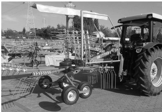
Рис. 11. Грабли в транспортной позиции (демонтированы только внешние плеча)
