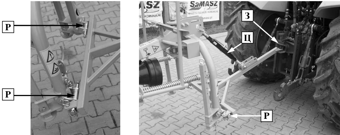
Рис. 14. Соединение граблей с трактором с помощью дышла
