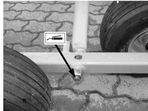
Рис. 29. Места смазки ездной тележки
