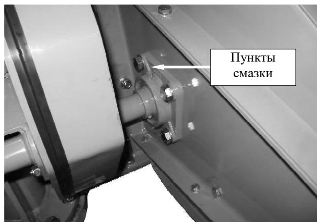
**Рис. 42.** Точки смазки самоустанавливающегося
