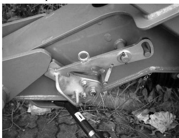
Рис. 23. Расположение защелки блокировки вне рабочей позиции
