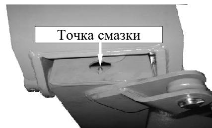
**Рис. 45.** Точка смазки втулки шарнира смазкой
