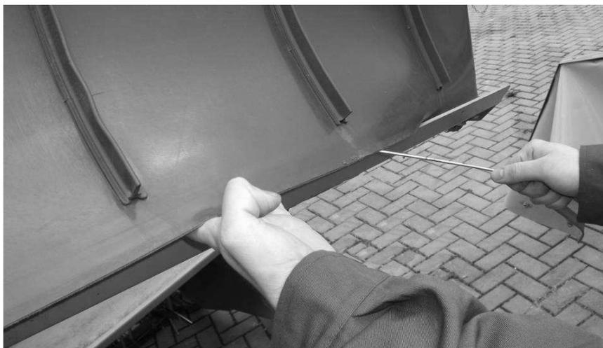
Рис. 41. Устранение загрязнений внутри ленты
