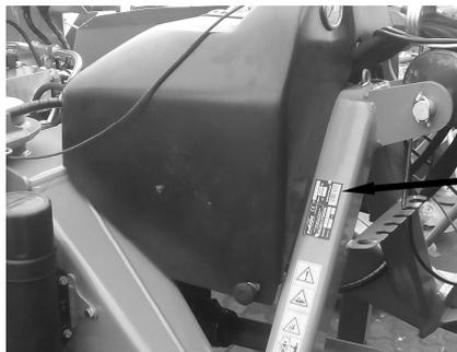
Рис. 1. Место прикрепления заводского щитка
