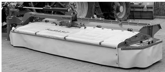
**Рис. 8.** Крепление брезентовой защиты на косилке
