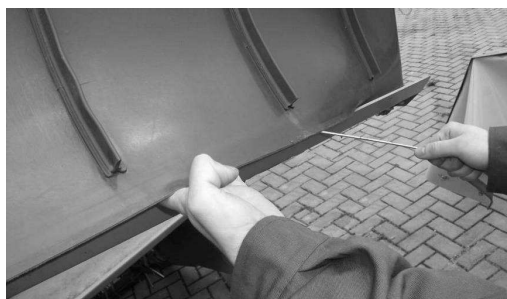
Рис. 37. Устранение загрязнений внутри ленты
