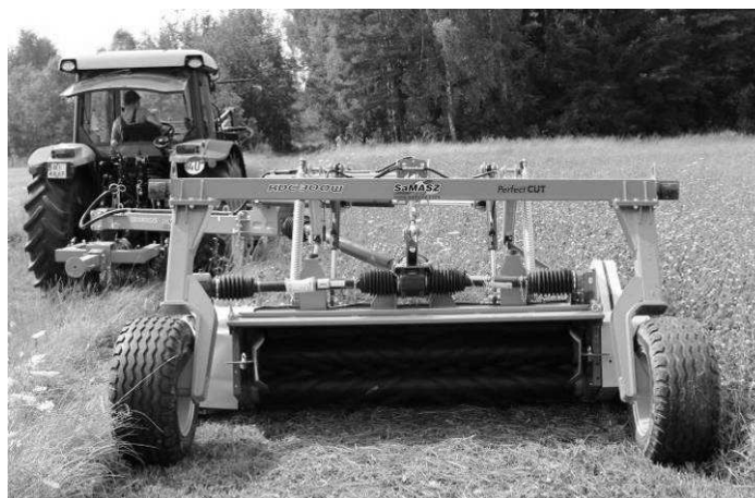
Рис. 16б. Рабочее положение косилки
