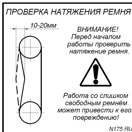
Рис. 35. Контроль и натяжение зубчатого ремня
