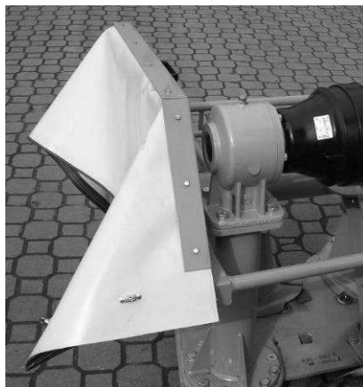
Рис. 10. Боковое ограждение косилки в транспортном положении
