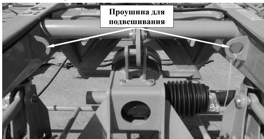
Рис. 5. Проушина для подвешивания косилки на крюк крана
