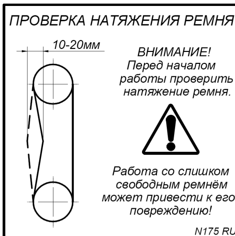
Рис. 28. Контроль и натяжение зубчатого ремня
