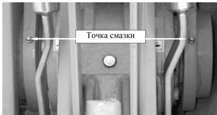
Рис. 37. Точки смазки обоймы навески
