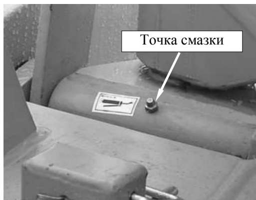
Рис. 36. Точка смазки вертикальной оси навесного устройства
