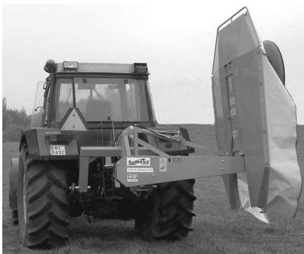
**Рис. 14а.** Транспортная позиция косилки - вид сбоку трактора
