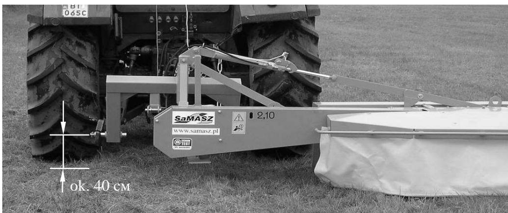
Рис. 23. Установка косилки в рабочую позицию
