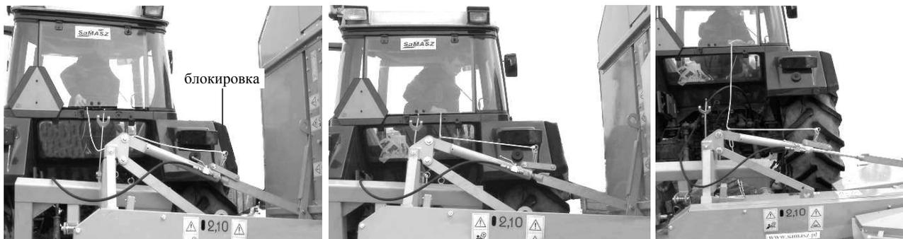
Рис. 17. Механическая блокировка гидравлического подъемника
