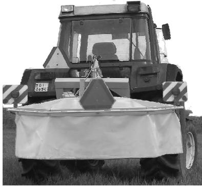
**Рис. 18.** Косилка (без гидравлического сервомотора) в транспортном положении с выделительными таблицами
