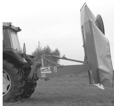
**Рис. 14б.** Транспортная позиция косилки – вид сзади трактора
