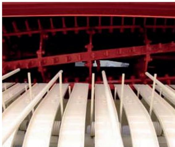
Цилиндр подборщика имеет бóльший диаметр и механизм для измельчения и расплющивания соломы.
