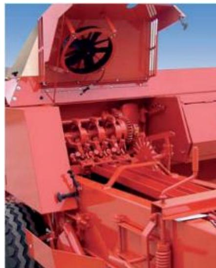
2 или 3 вязальных аппарата с вентилятором для очистки в стандартной комплектации
