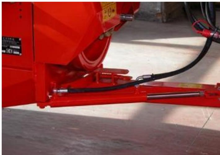
**Гидравлическое смещение дышла** позволяет оператору быстро перейти из рабочего положения в транспортное не выходя из кабины трактора.
