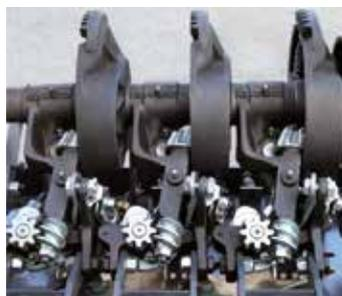
Простой и надежный механизм узловязателей, позволяет работать даже в самых экстремальных условиях. Специальная система, контролирует натяжение шпагата и минимизирует нагрузку на узловязателях. Блок узловязателей очищается двумя (HD870) или тремя (HD1270) высокопроизводительными вентиляторами, устраняя саму возможность забивания
