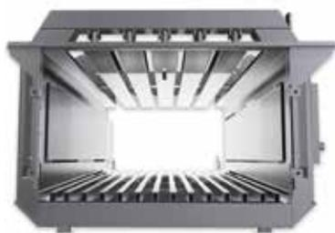
Камера изготовлена с применением прочнейших на сегодняшний день сталей Weldox и Hardox. Не имеет традиционных направляющих для хода поршня внутри камеры прессования. Простая, но прочная конструкция рассчитана на многолетнюю эксплуатацию в тяжелых условиях, а также снижает энергопотребление при формировании тьюка
