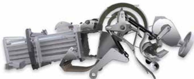
Серия тьюковых прессов HD оснащена запатентованной технологией, основанной на «системе рычагов Архимеда» с балансирами, позволяющей выдавать высокую прессуемую мощность 18 тонн в камере прессования, потребляя при этом только 80 л.с. мощности на ВОМ трактора. Это позволяет использовать даже средномощные тракторы с крупнопакующими прессами серии HD, минимизировать затраты и производить тьюки с самой низкой себестоимостью на рынке.
