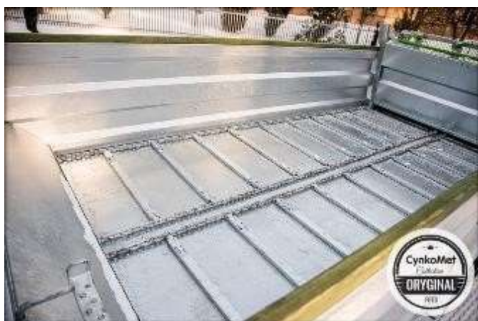
Цепной транспортер горячей оцинковки (14мм). A4VS адаптер для равномерного внесения удобрений
