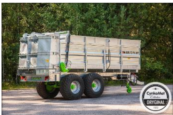
Борты 1000 + 350мм Полезная ёмкость кузова 15,3м3. Агрегатирование с МТЗ-1221
