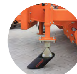
Скользящие полозья Küper. Высокотехнологичный материал, долговечный, высочайшей прочности.
