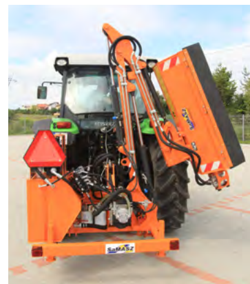
Позиция для транспортировки - рабочий орган не заслоняет задний бампер с фарами.
