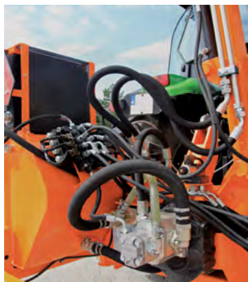
Независимая гидросистема вместе с распределителем - высокая производительность и надежность.
