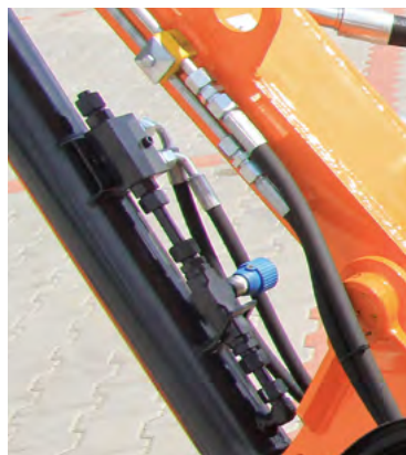
Гидравлический ригель на главном цилиндре вместе с регулируемым дроссельным клапаном.
