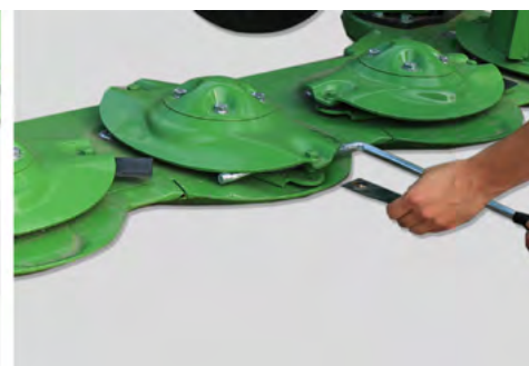
Быстрая замена ножей выполняется с помощью специального ключа, находящегося в стандартной комплектации каждой косилки.
