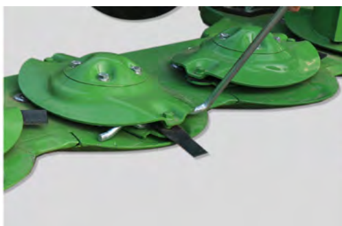
Быстрая замена ножей выполняется с помощью специального ключа, находящегося в стандартной комплектации каждой косилки.
