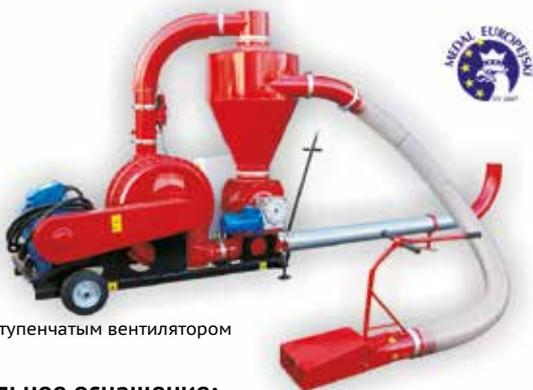
T-449/2 с трехступенчатым вентилятором
