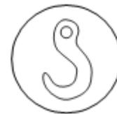
**Точки крепления для подъема.** Этот сигнал указывает точки, которые следует использовать для подъема машины. Этот сигнал указывает как точки подъема с помощью крана, так и точки подъема с помощью домкратов. Методы и соответствующие точки подъема подробно описаны в соответствующих главах.
