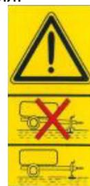
**Внимание.** Используйте дополнительную опору, если стояночный домкрат машины стоит на очень мягком грунте.
