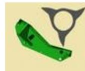
Этот значок указывает на то, что нижняя камера находится в закрытом положении, то есть в том положении, в котором она должна находиться при сборе.
