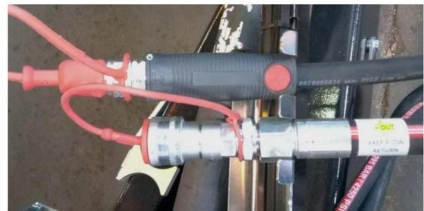
Рис. 18 – Гидравлические соединения пресс-подборщик-трактор
