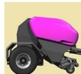
Фиолетовый пресс-подборщик указывает на то, что достигнут максимальный уровень давления. Этот значок появляется только в том случае, если установлен режим ручного запуска обвязки, в противном случае статус рулонного пресс-подборщика сразу переходит в состояние «выполняется обвязка».
