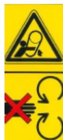
**Опасность защемления и порезов верхних конечностей.** Не приближайтесь к вращающимся частям во время движения пресс-подборщика или трактора. Во время технического обслуживания машины обязательно выключайте двигатель и блок управления.
