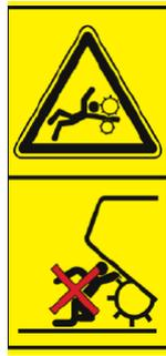
**Внимание.** Не приближайтесь к частям подачи во время движения рулонного пресс-подборщика или трактора. Во время технического обслуживания машины обязательно выключайте двигатель и блок управления.
