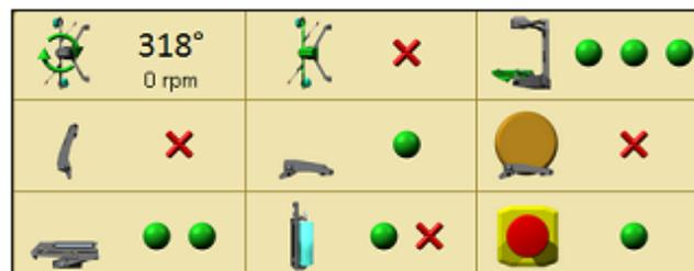
Значки платформы, вил и щипцов графически представляют положение соответствующего органа.
