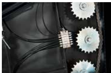
Централизованная смазка подшипников и основных узлов
