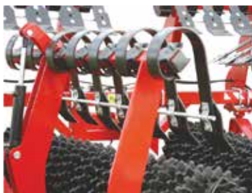
Пружинная волокуша с гидравлической регулировкой к каткам „ТУТАН“
