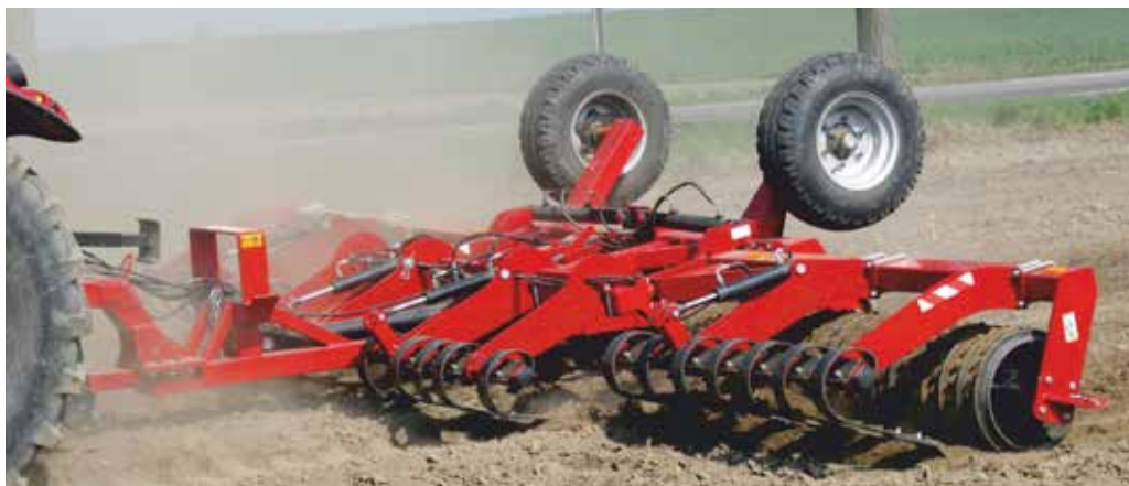
Пружинная волокуша с гидравлической регулировкой к каткам „ТУТАН“
