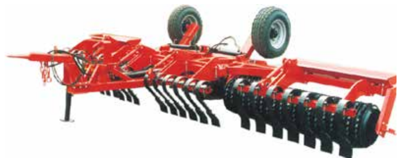
Пружинная волокуша с гидравлической регулировкой к каткам „ТУТАН“
