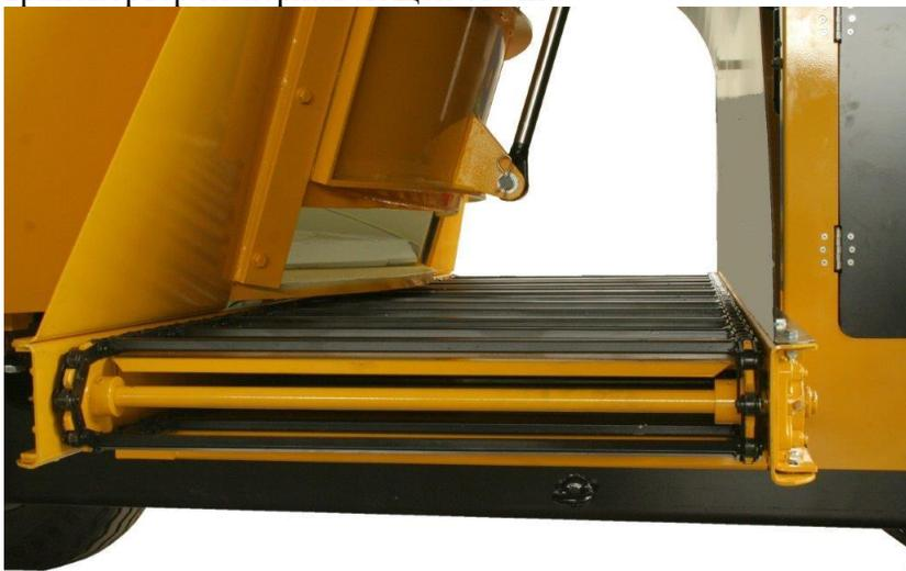
Дополнительное выгрузное окно справа с цепным выгрузным конвейером L1000мм (гидравлическая регулировка высоты)
