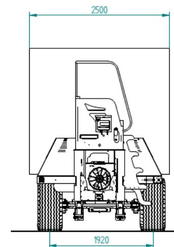
При исполнении на двухосном шасси колеса **435/50 R 19,5** (одинарные, рассчитаны на нагрузку 5400 кг/каждое). Тандемная подвеска, первая ось фиксированная, вторая управляемая на рессорах.
