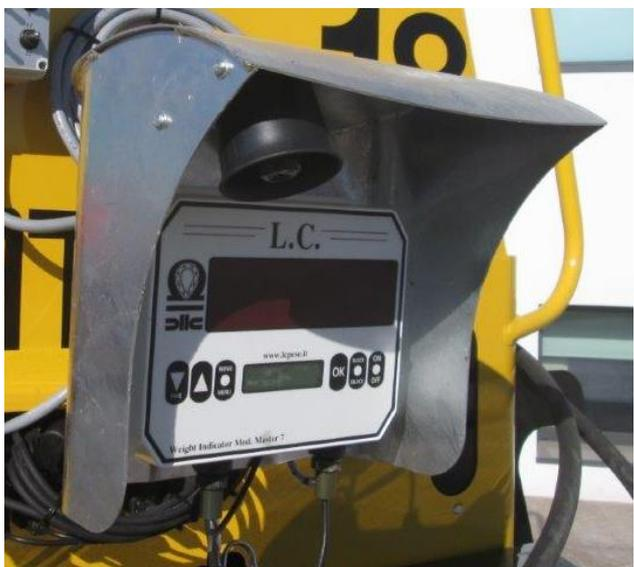
Весовая система LC.мод.Winfarm (20 рецептов x 50 компонентов, 20 раздач) установлена на поворотном кронштейне. Весовые тензоры из нержавеющей стали.
