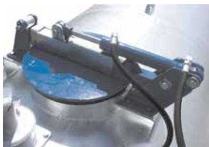
Гидравлически открываемый верхний люк, Ø420
