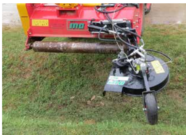
Версия BDR - привод от собственной гидравлической системы
