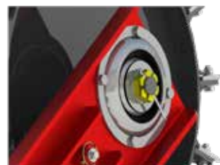
Подшипник с резиновым амортизатором
