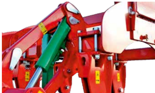
гидроцилиндр. Версия "Н" с гидравлической защитой
