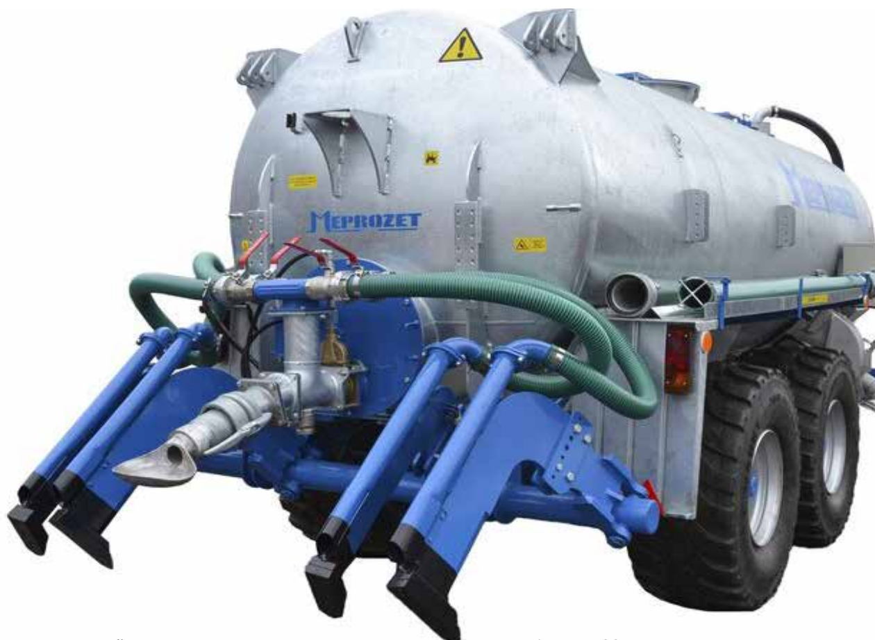
Четырехсошниковый аппликатор для внесения навоза в почву на глубину до 20 см.
