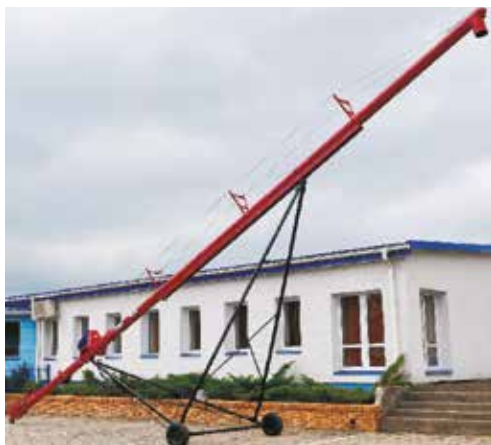
Т - 447 с диаметром труб 200 мм, мощностью двигателя 11 кВт, производительностью 48 т/ч для пшеницы с углом наклона 40°
