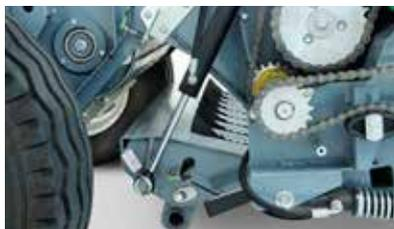
Система электро-гидравлического контроля позволяет контролировать и изменять плотность прессования из кабины трактора.
