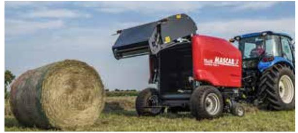
**Стандартное оснащение (базовая версия):** Подборщик 1,7м, обвязка двойным шпагатом, механическое управление обвязкой (M50 акустический сигнализатор), механический контроль плотности рулона, механическая блокировка камеры, транспортная сигнализация, механический счетчик рулонов, толкатель рулонов, карданный вал, колеса 10,0/75-15
