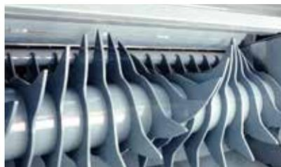
Антизакупорочная система подборщика (гидравлически опускаемый модуль) контролируется оператором при помощи пульта из кабины трактора
