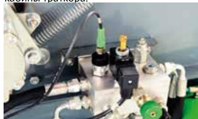
Автоматическая смазка цепей увеличивает срок эксплуатации машины, а централизованная смазка подшипников экономит время оператора и максимально упрощает процедуры технического обслуживания.
