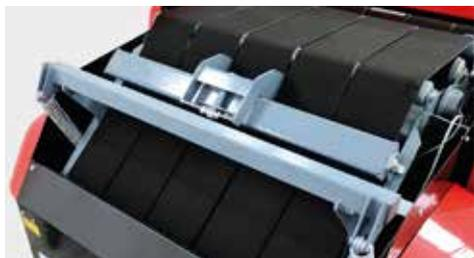
Комплект фальш-ножей (для работы без забивания с отключенной системой измельчения)
