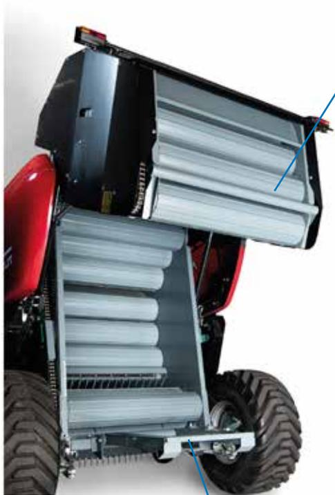
**ФИКСИРОВАННАЯ ВАЛЬЦОВАЯ КАМЕРА**
