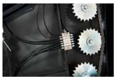
Централизованная смазка подшипников и основных узлов
