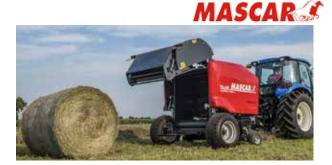
**Стандартное оснащение (базовая версия):** Подборщик 1,7м, обвязка двойным шпагатом, механическое управление обвязкой (М50 акустический сигнализатор), механический контроль плотности рулона, механическая блокировка камеры, транспортная сигнализация, механический счетчик рулонов, толкатель рулонов, карданный вал, колеса 10,0/75-15
