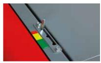
Механическая блокировка камеры позволяет формировать более плотный рулон при меньшей нагрузке на гидравлическую систему трактора
