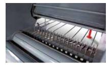
Регулировка плотности рулонов с механическим указателем уровня давления в прессовальной камере
