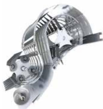
Простой и надежный механизм узловязателей, позволяет работать даже в самых экстремальных условиях. Специальная система, контролирует натяжение шпагата и минимизирует нагрузку на узловязателях. Блок узловязателей очищается двумя (HD870) или тремя (HD1270) высокопроизводительными вентиляторами, устраняя саму возможность забивания
