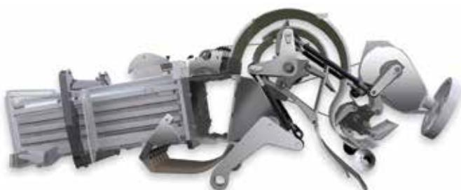
Серия тюковых прессов HD оснащена запатентованной технологией, основанной на „системе рычагов Архимеда” с балансирами, позволяющей выдавать высокую прессуемую мощность 18 тонн в камере прессования, потребляя при этом только 80 л.с. мощности на ВОМ трактора. Это позволяет использовать даже среднемощные тракторы с крупнопакующими прессами серии HD, минимизировать затраты и производить тюки с самой низкой себестоимостью на рынке.
