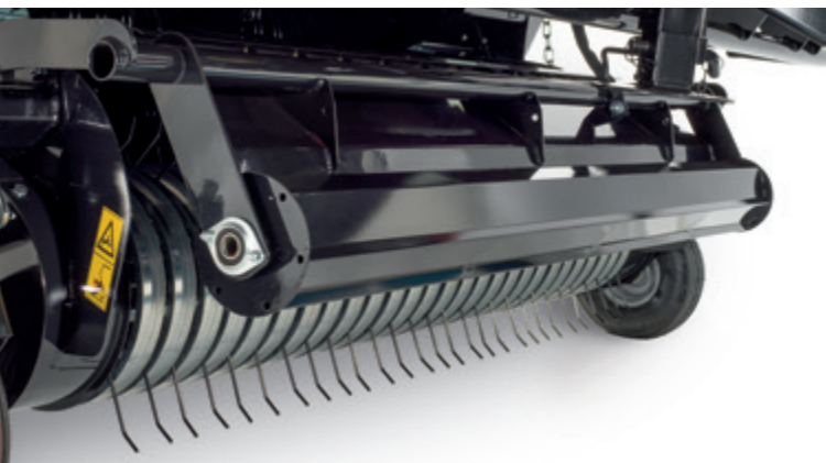
Rullo premi falda (optional per SMART) Roll crop guard (optional for SMART) Rollen-niederhalter (optional für SMART) Rolka dociskowa (opcja dla SMART) Ролик для прижима продукции (опция для SMART)
