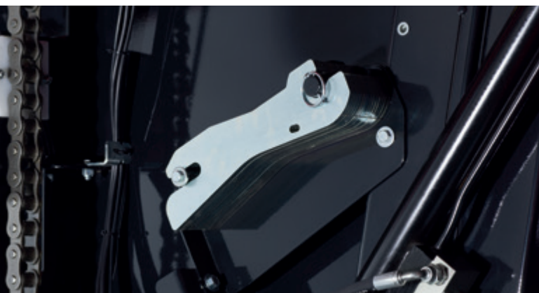
Kit falsi coltelli Fake knives kit Blindmessern Satz Zestaw atrap noży Набор фальш ножей
