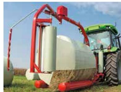
**Стандартное оснащение:** Натяжитель (алюминевые вальцы) пленки 50-75 см., управление гидравлическое, электронный счетчик количество оборотов, наслоение пленки 2+2, автоматический отрез пленки.
